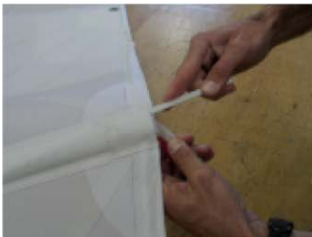
Glisser le chausse latte sur le dessus de la sangle en maintenant la garcette à l'extérieur du gousset.
